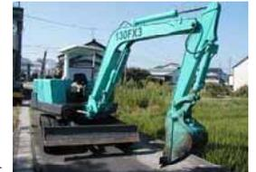
下水道建設工事では、狭い公道上で掘削機械を利用して溝掘削作業を行う場合には、公道を通る自動車や構築物等と当該掘削機械との間に労働者が挟まれる災害を防止するため、掘削用機械の旋回範囲内への立入りを禁止する等の措置を講ずる。掘削機械を用いて、土止め用矢板、ヒューム管等の吊り上げ作業を行う場合には、移動式クレーン又はクレーン機能を備えたドラッグショベルを使用する。
